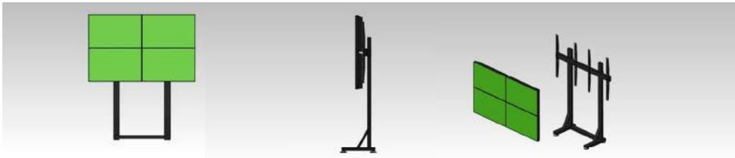
Toda esta configuración deberá estar hecha a medida para la UCO del estadio, para ello el soporte permitirá el ajuste en altura y va provisto de canalizaciones para los cables de video y alimentación. Hará falta una estructura de este tipo para soportar los 4 monitores videowall en formato 2x2.
